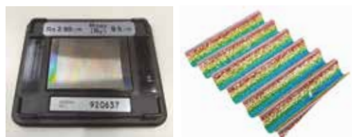
Campione di rugosità 3 \mu\text{m}
