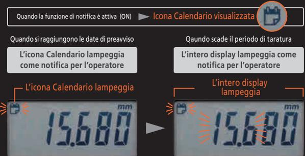
È possibile impostare facilmente sia la data di preavviso di scadenza della taratura, sia la data di effettiva scadenza. All'avvicinarsi della data di preavviso e della data di scadenza viene visualizzato un avviso per evitare di saltare la taratura. Si tratta di una funzione efficace per una corretta gestione del micrometro Digimatic.
