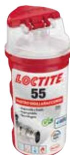
Certificato DVGW/KTW per gas ed acqua potabile, per raccordi fino a 4", applicabile su filettature in plastica e metallo, sigillatura istantanea in quanto non necessita di polimerizzazione, riposizionabile per consentire l'allineamento di valvole, rubinetti o raccordi.
