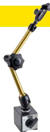
Base magnetica disinseribile mediante chiaffetta, superficie d'appoggio con sagoma a V che consente ancoraggi anche su superfici curve, asta di colore giallo con snodi, chiusura meccanica centrale, attacco universale con regolazione fine.
