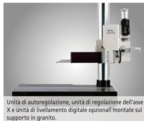
Unità di autoregolazione, unità di regolazione dell'asse X e unità di livellamento digitale opzionali montate sul supporto in granito.
