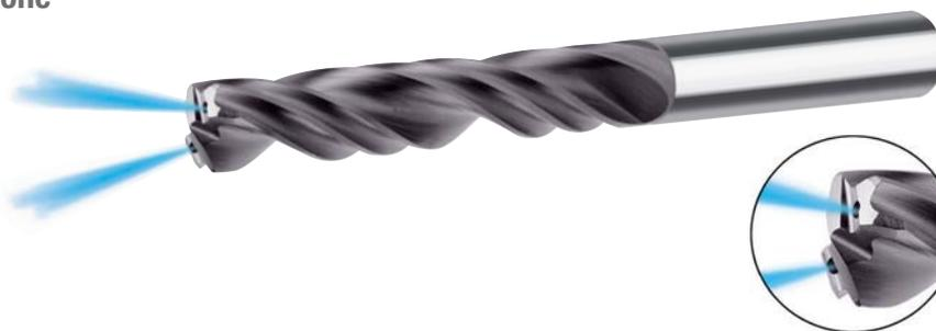
Punta alesatrice codolo cilindrico in **metallo duro integrale**, 4 taglienti per eseguire in un'unica operazione la foratura e l'alesatura con una tolleranza raggiungibile IT7, rivestita TiAIN 5xD, **con fori di refrigerazione**. Le caratteristiche tecniche di questa punta alesatrice consentono di eseguire in una sola operazione la foratura con la stessa qualità di superficie, precisione delle dimensioni e rotondità come nelle alesature, di fatto vengono ridotti i tempi.
