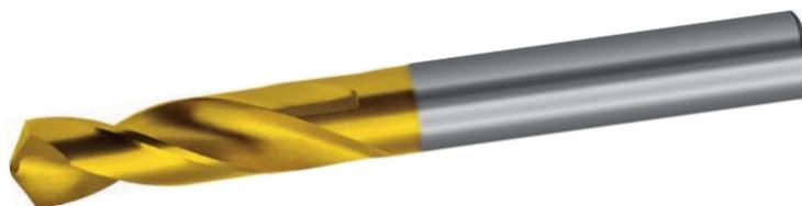
Punta codolo cilindrico in **metallo duro integrale, rettificata**, rivestita TiN, serie extracorta, norma DIN 6539, angolo affilatura 118°. **Per lavorazioni di acciai legati e non, ghise, leghe di alluminio e materiali non ferrosi.**
