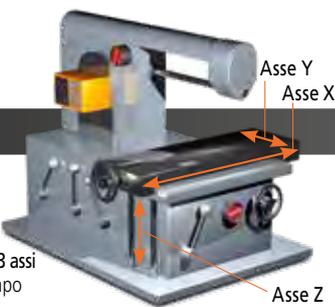
VISUALIZZATORE KA-200 a 3 assi + tre righe ottiche, campo max. effettivo di 3.000 mm
