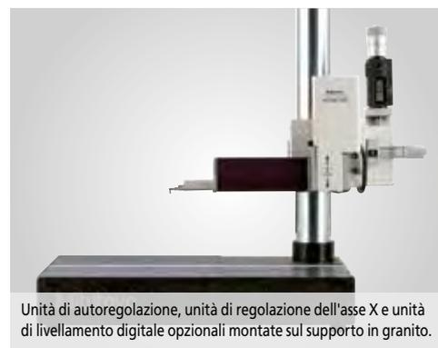
Unità di autoregolazione, unità di regolazione dell'asse X e unità di livellamento digitale opzionali montate sul supporto in granito.
