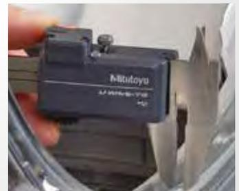
U-WAVE-T con cavo di collegamento (acquistabile a parte) per differenti strumenti Digimatic.
