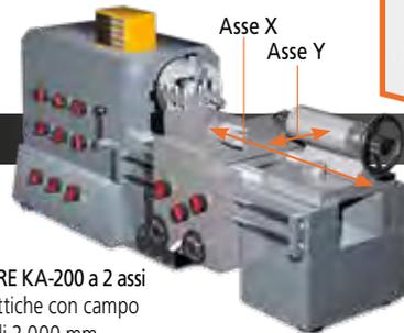
VISUALIZZATORE KA-200 a 2 assi + due righe ottiche, campo max. effettivo di 2.000 mm
