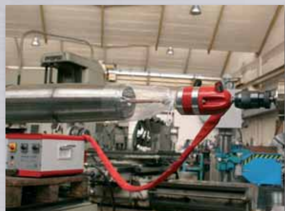
Elettroerosione orizzontale su un'alesatrice. Al posto della punta viene serrata nella macchina la testa oscillante dell'apparecchio di elettroerosione
