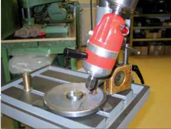
Elettroerosione di fori obliqui
